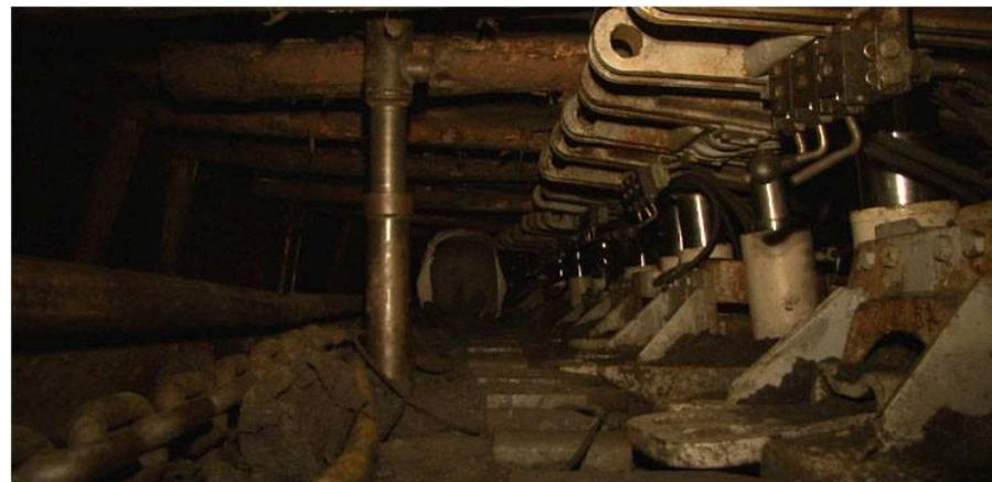
1er septembre. Image #9 / Plaques de soutènement. Elles pèsent plusieurs centaines de tonnes et sont montées sur vérins hydrauliques. Elles supportent les 400 mètres de terre au dessus de nos têtes. Hauteur de la galerie : entre 50 et 70cm dans lesquels il faut pouvoir ramper et travailler.
