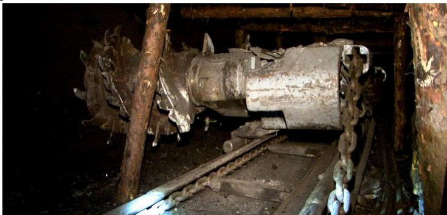
31 août. Image #8 / Haveuse avant l'extraction. En mouvement c'est le chaos, la poussière et l'aveuglement. La machine, guidée par les mineurs à la main, glisse sur les rails et croque la houille. Le charbon est emporté sur le tapis. Je me rappelle avoir pris pas mal de risque pour filmer ses dents à 15cm en action, le tout en ayant pleinement conscience qu'un seul faux mouvement pouvait me broyer les mains.
